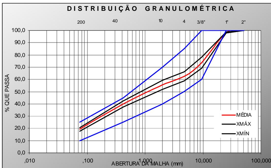
Faixa granulométrica da mistura: Material enquadra na faixa "D" da especificação DNIT 141/2010 - ES – Base Estabilizada Granulometricamente.
