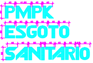
DETALHE DO TAMPAO DO POÇO DE VISITA
