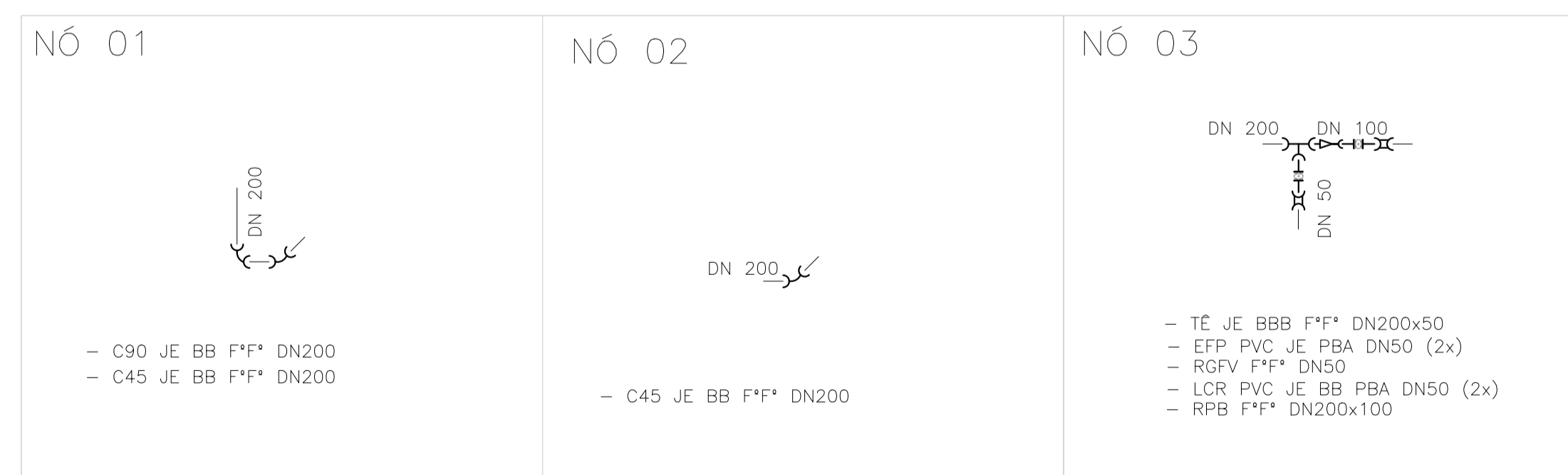
DETALHE DOS NÓS – INTERLIGAÇÃO ESC.: S/ESCALA
