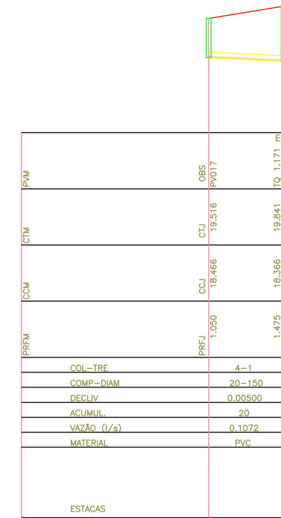
REDE COLETORA DE SÃO PAULO. COLETOR 4 - PERFIL escala: H.: 1/1000 V.: 1/100
