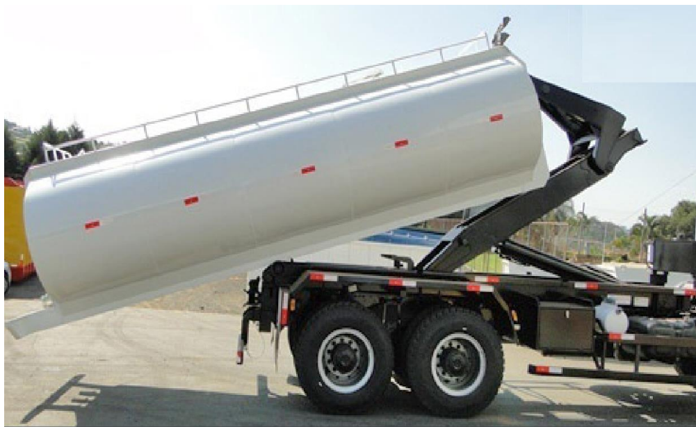
Imagem 06: Modelo de caixa tanque para armazenamento de efluente.
