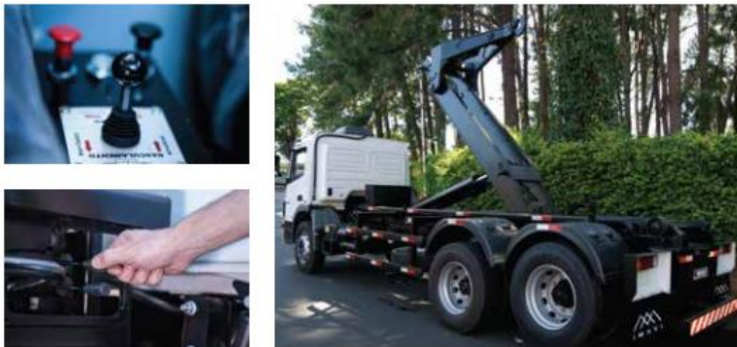
Imagem 04: Veículo com equipamentos Roll-On/Roll-Off e operação com acionamento primário.
