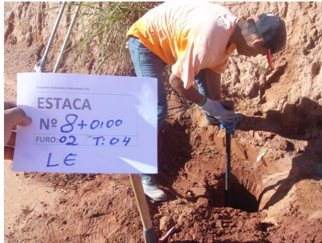
Figura 01: Solo argilo-arenoso de boa consistência, sem presença de nível d'água.
